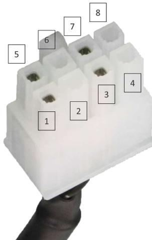
Abb. 3: Molex-Stecker PIN-Belegung
