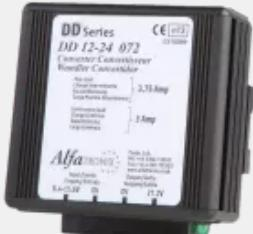
DC-DC Wandler in kompakter Schaltnetztechnik mit Schutzzart IP53. Der DD12-24 072 12-24V/3A ist rüttel- und vibrationsfest und stellt bei einer Eingangsspannung von 12 VDC eine stabile Ausgangsspannung von 27,2 VDC mit bis zu 3 A (Dauer), 3,6 A (2 min) bereit. Er zeichnet sich durch einen hohen Wirkungsgrad von >93% aus und kann in einem Temperaturbereich von -25 ... +80°C betrieben werden. Der Anschluss erfolgt per 6,3 mm Flachsteckverbindung.
