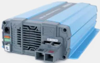
Der 1.000-W-Wechselrichter der SE-Serie von Cotek wandelt mit modernster Technologie eine 12-V-Gleichspannung in eine reine 230-V-Sinus-Wechselspannung. Am Eingang ist der Cotek Wechselrichter gegen Verpolung-, Unterspannung sowie Überspannung geschützt. Am Ausgang gegen Kurzschluss, Überlast und Übertemperatur.
