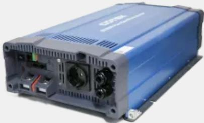
Der 3.500-W-Wechselrichter der SD-Serie von Cotek wandelt mit modernster Technologie eine 24-V-Gleichspannung in eine reine 230-V-Sinus-Wechselspannung. Am Eingang ist der Cotek Wechselrichter gegen Verpolung-, Unterspannung sowie Überspannung geschützt. Am Ausgang gegen Kurzschluss, Überlast und Übertemperatur.
